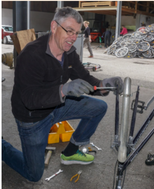
Helfer zerlegen die Räder für den Transport, Pedale runter und Vorderrad raus.
